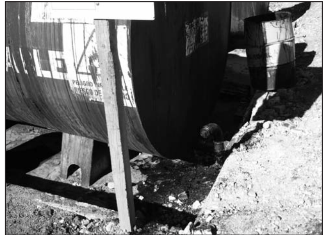
Figura 12. Derrame de asfalto en la carga.
