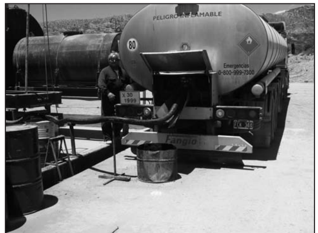
Figura 13. Correcta práctica en la carga de asfalto.
