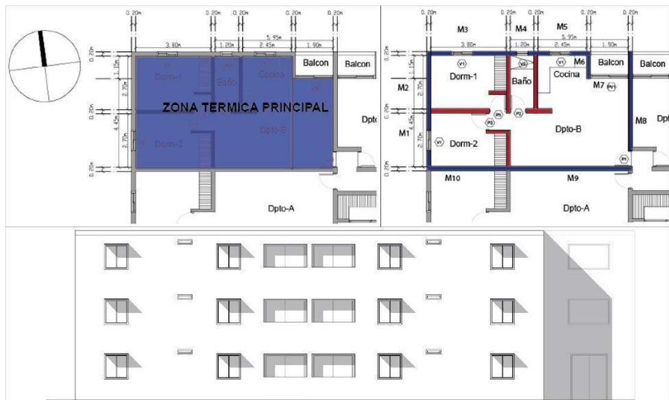
Figura 7. Zona térmica, Planta y vista parcial del edificio de la unidad evaluada. Fuente: Elaboración Propia.
