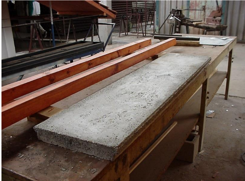
Foto 5. Placa de ladrillos con PET reciclado. Fuente: archivo fotográfico de CEVE.
