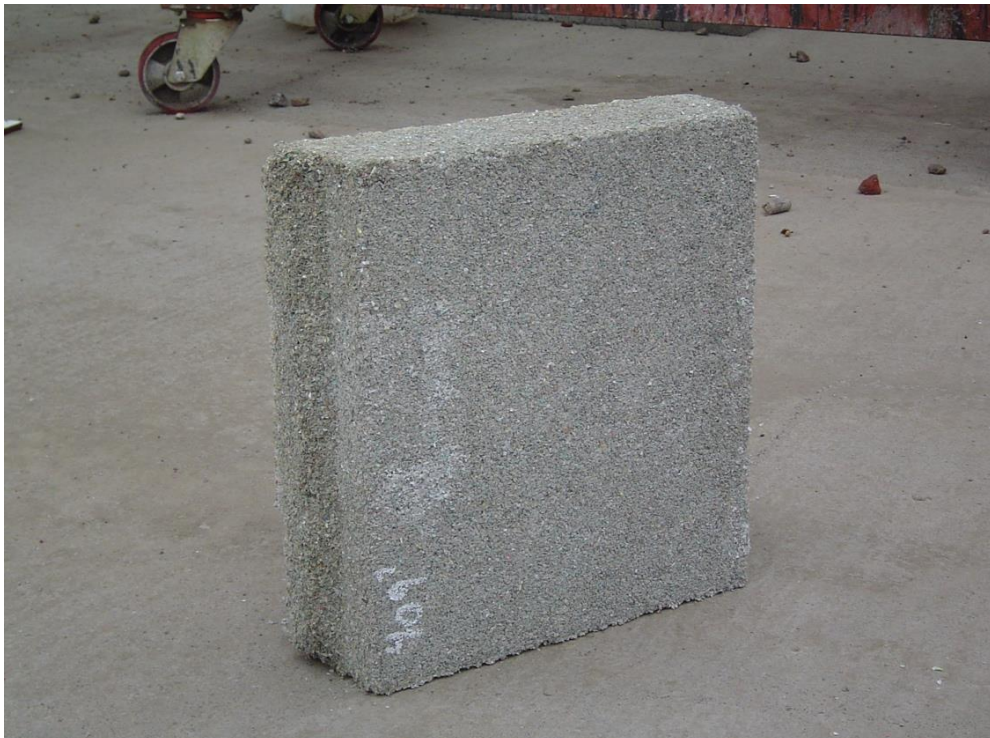
Foto 8. Ladrillón de PET y cemento, y montaje de un muro. Fuente: archivo fotográfico de CEVE.
