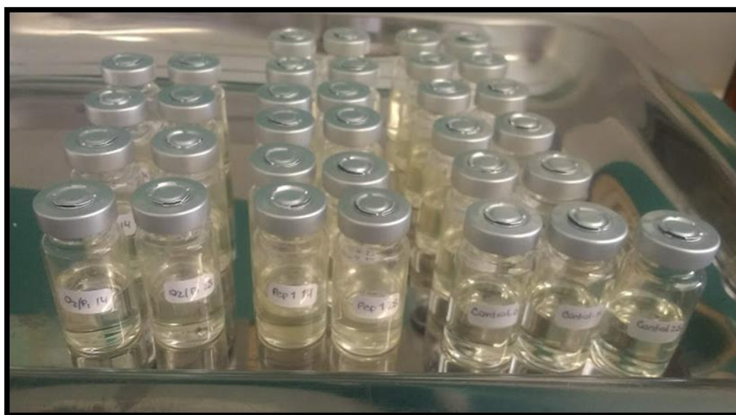
Figura 2: Viales que contienen muestras del aceite de girasol con el agregado de mezclas de aceite esencial para determinación de compuestos volátiles por medio de CG-MS.
