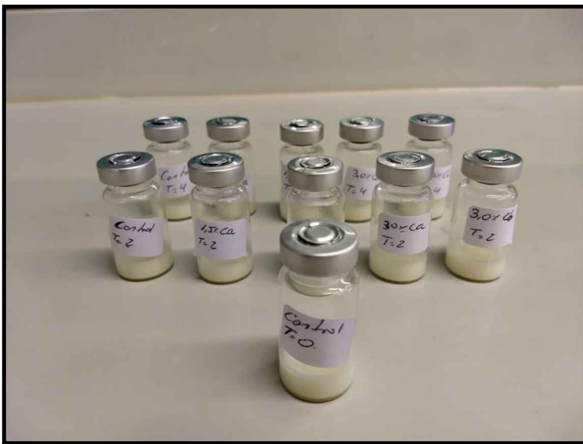
Figura 6. Viales para la determinación de compuestos volátiles de fermentación por medio de cromatografía gaseosa acoplada a detector de masa (CG-MS).
