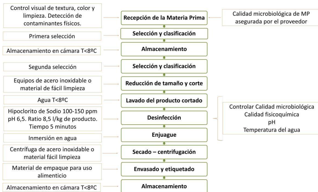
Figura 2: Diagrama de flujo del proceso optimizado de elaboración de rúcula lista para consumo
