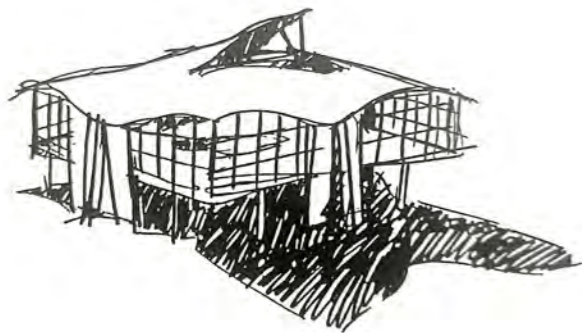
Intercambiador de transporte. Se han utilizado las posibilidades de láminas con bordes libres para construir grandes voladizos. Las discontinuidades permiten aberturas para iluminar el interior.
