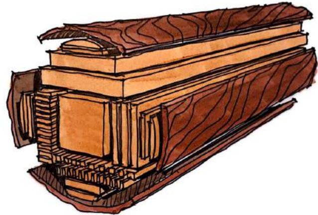
Diferentes formas de aserrar un tronco
