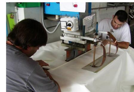
PROCESO DE UNIÓN SOLDADA DE LA TELA CON CUÑA CALIENTE
