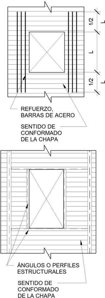
proximidades de los apoyos para evitar las máximas solicitaciones de corte. En su defecto, además de los refuerzos requeridos a flexión, deberá verificarse la resistencia al corte de la sección y colocarse refuerzos si hicieran falta.
