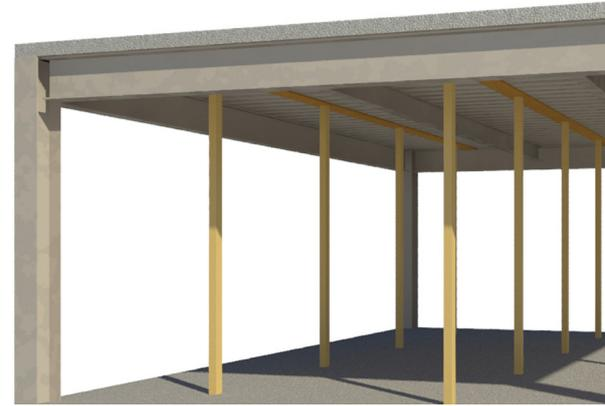
Alternativa 2: Para la losa de 155 mm con chapa calibre 18, se modifica el módulo de vigas respetando la separación máxima indicada en la tabla anterior para así evitar el apuntalamiento temporal.
