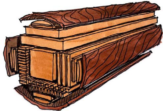
Diferentes formas de aserrar un tronco
