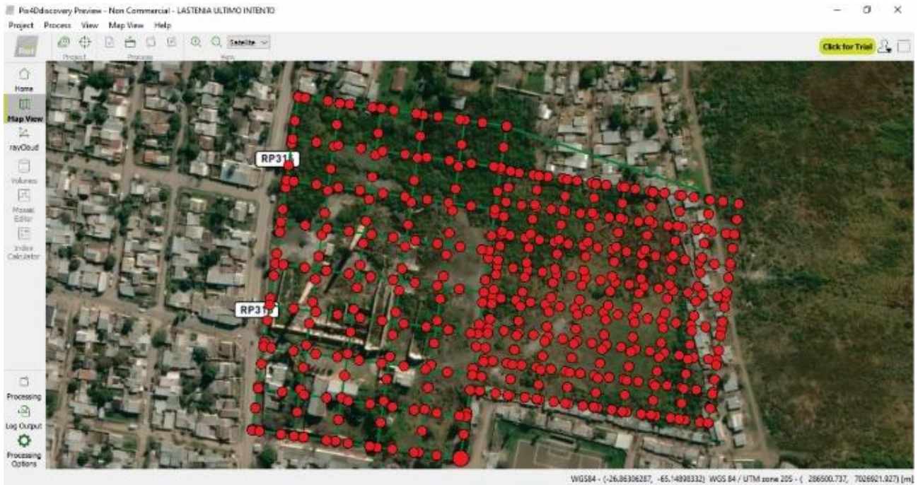
Figura 2. Esquema de ruta de vuelo realizado por el dron DJI Phantom 4 Pro sobre el SIL.
