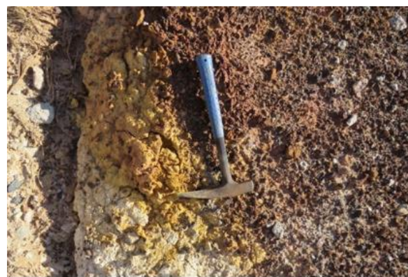
Figura 7. Mina Eva Perón. Veta de óxidos de manganeso intruyendo rocas de la Fm. Marifil (arriba). Mina Eva Perón. Hidróxidos de hierro (limonita-ocres) en zona de alteración de la Fm. Marifil (abajo).
