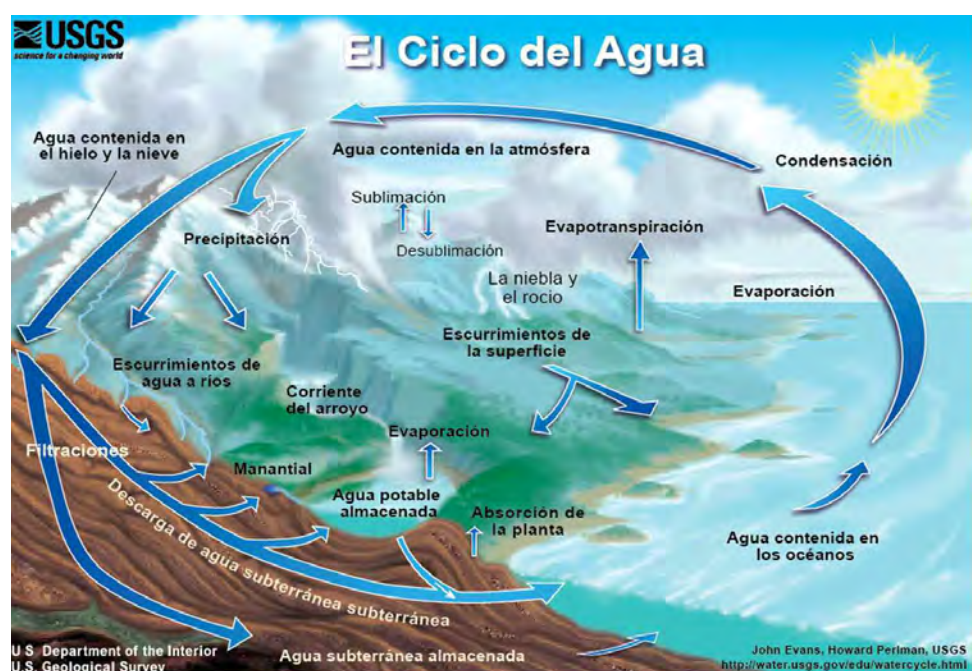
Figura 2. Ciclo del Agua y los procesos verticales (precipitación, evaporación, transpiración, infiltración en el suelo) y horizontales (escurrimientos) que comunican los reservorios de la hidrósfera. (Tomado de http://ga.water.usgs.gov/edu/water-cyclespanish.html )
