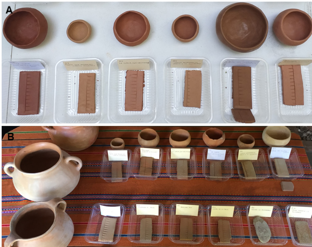
Figura 5. Procedimientos experimentales aplicados sobre las muestras de arcillas: a) Vasijas y briquetas experimentales confeccionadas con arcillas de ANS; b) Cocción del material cerámico; c) Vasijas y briquetas después de la cocción
