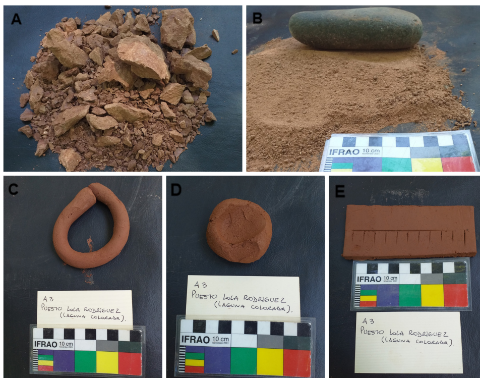
Figura 4. Procedimientos experimentales aplicados sobre las muestras de arcillas: a y b) Proceso de molido; c) Confección de rollos; d) Realización de esferas; e) Manufactura de briquetas
