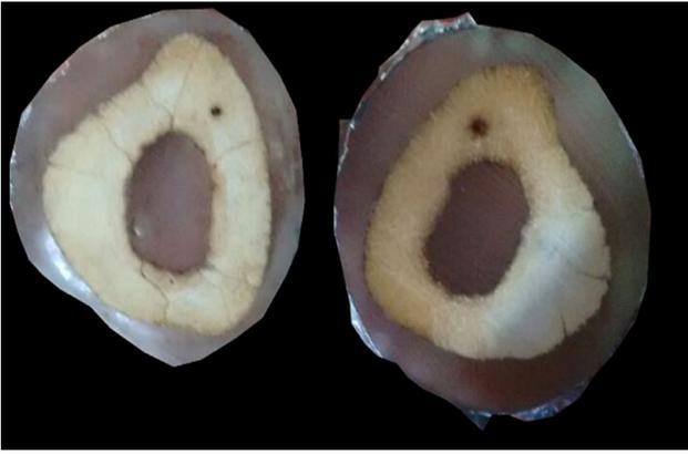
**Figura 3:** Pastilla obtenidas a partir de la inclusión de la muestra en resina. Se muestran las caras pulidas.
