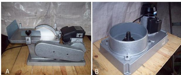
**Figura 1:** Equipo: A Sierra de precisión. B Desbastadora automática.
