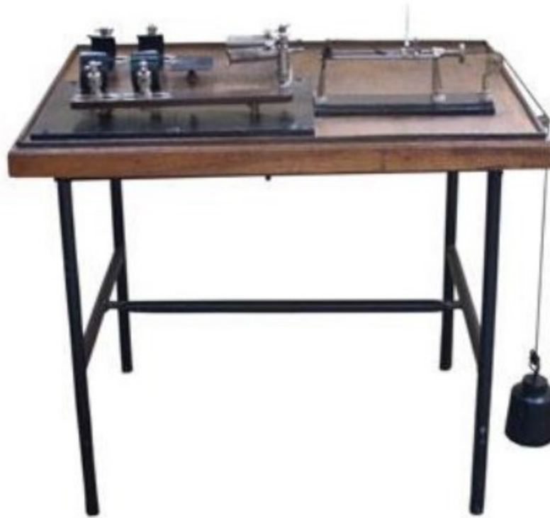
Figura 1: Ergógrafo de Mosso utilizado por Palacios.
