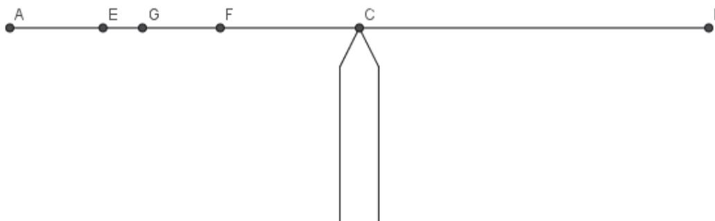
**Figura 5.** Diagrama de la balanza propuesta por Galileo.
