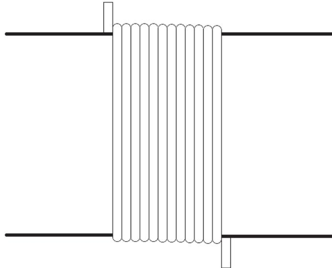
**Figura 6.** Esquema del método de la disposición del alambre en la balanza propuesta por Galileo para medir diferencias entre los puntos de equilibrio. El estilete es pasado por las minúsculas depresiones entre cada vuelta del alambre, produciendo un sonido.
