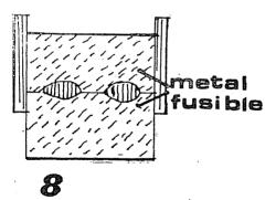
sector de metal fusible está bien frío, el segundo sector, no se adherirá. Separar ambos, y retirar los dientes de metal K., así esta mufla y contra nu la, nos permitirá prensar dientes de acrílico de termocurado, tantas veces como los necesitemos, del color o matiz deseado (Fig. Nº 9 y 10). Prensar y curar el acrílico se hará en
