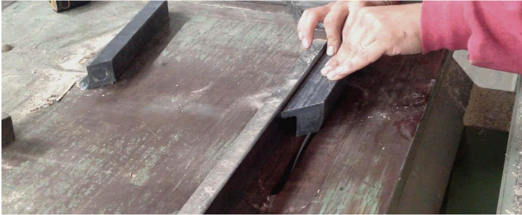
Figura 4. Aserrado longitudinal de perfiles para colocación de vidrio y perfilación de cortes menores a 10mm.
