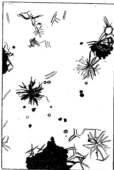
FIGURA 12 bis. — Dibujo sobre la microfotografía para destacar la orientación de las agujas.
