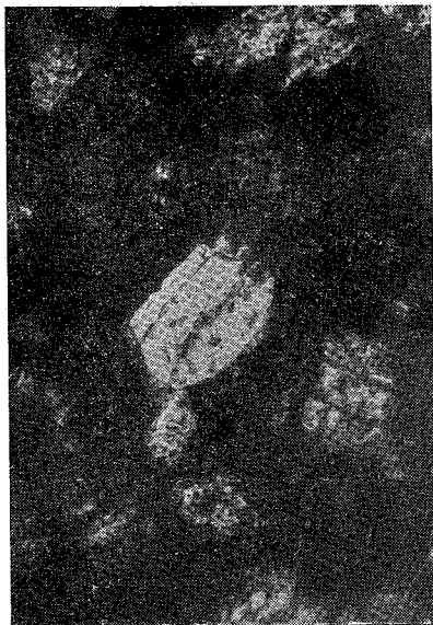
FIGURA 4. — Cristales de alita mostrando las líneas de clivaje. Aumento 500. Nicoles \perp .
