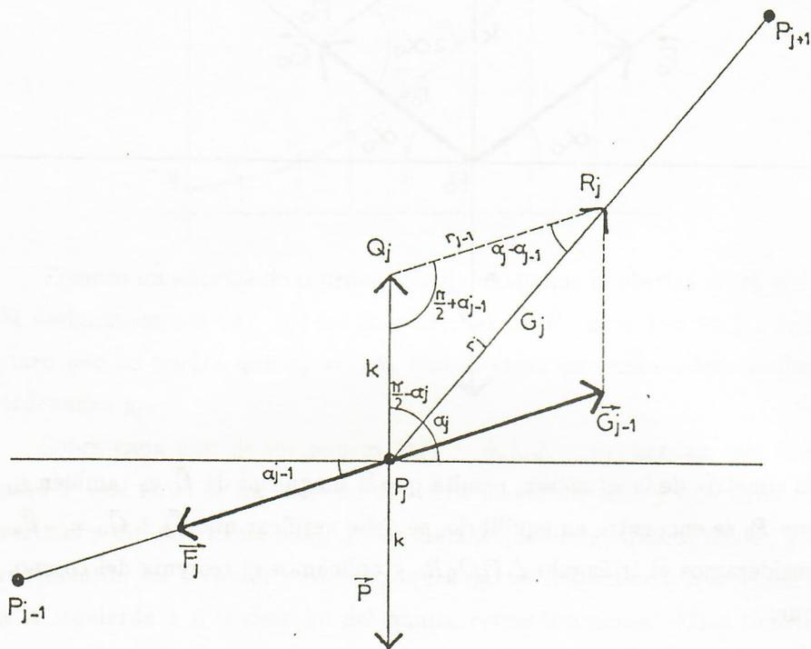
La condición (1) puede escribirse ahora en la forma:  $\vec{G}_{j-1} - \vec{P} = \vec{G}_j$ . Si consideramos ahora el triángulo  $\triangle P_j Q_j R_j$  y aplicamos el teorema del seno, obtendremos:
