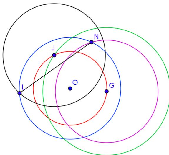
FIGURA 2.8. construcción de la cuarta proporcional.
