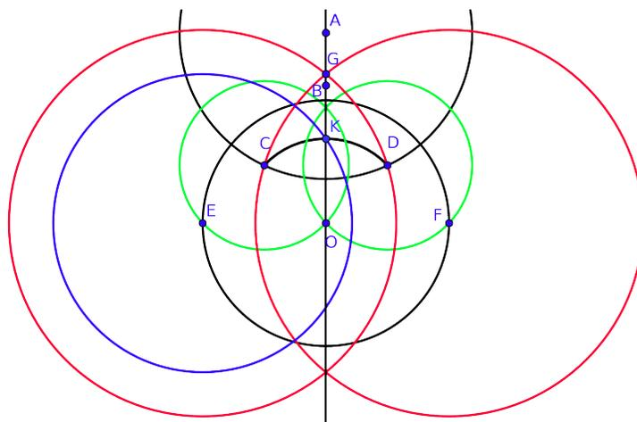
FIGURA 2.7. construcción de la intersección de una circunferencia y una recta que pasa por su centro
