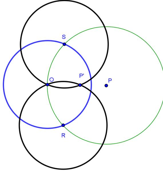
FIGURA 2.2. Construcción del inverso de un punto con respecto a una circunferencia.
