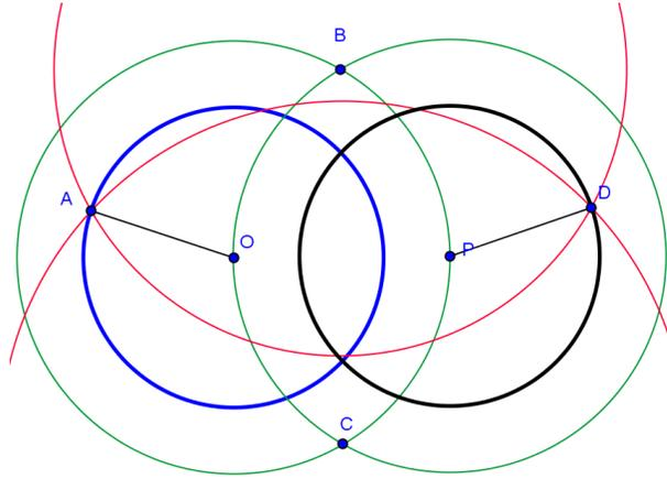
FIGURA 2.1. Construcción de una circunferencia con el mismo radio que una dada.
