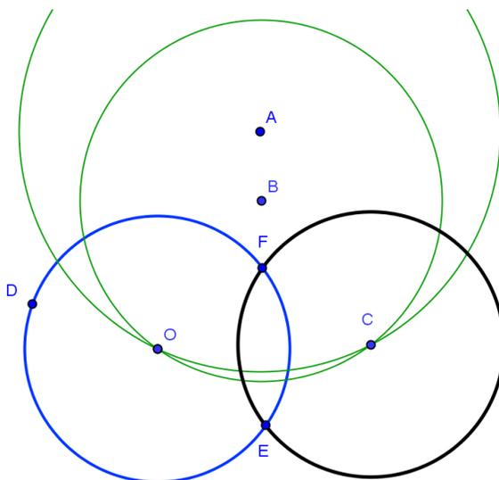
FIGURA 2.6. Construcción de la intersección de una circunferencia y una recta que no pasa por su centro
