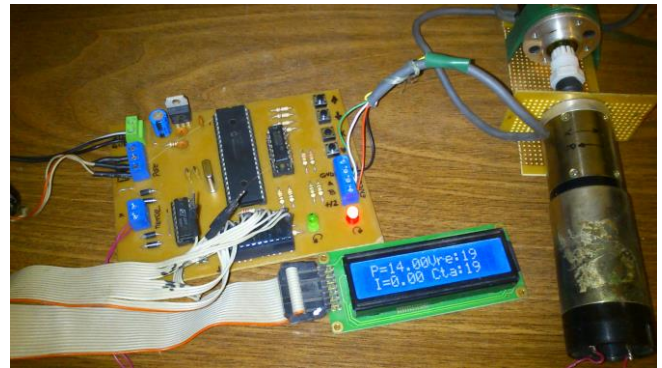
Fig. 11: Implementación de los alumnos del Controlador discreto y driver de motor DC.
