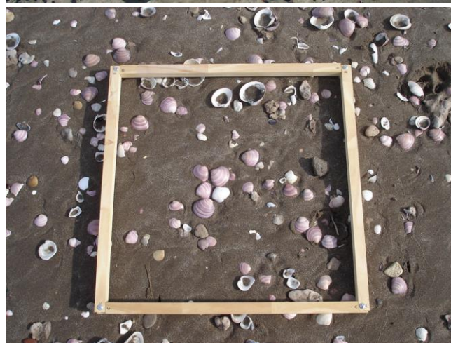
Fig. 7: Muestreador “cuadrata” utilizado para coleccionar valvas de moluscos actuales. Este instrumento permite realizar la recolección superficial de las valvas contenidas en 1 \text{ m}^2 . Dicho procedimiento se repite n veces en cada sitio.
