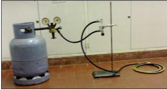
**Fig.4:** Cilindro de GLP utilizado para la inyección.
