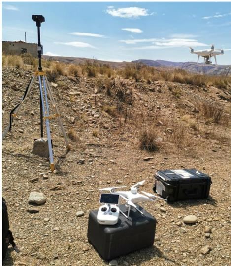
Fig. 3: Equipo Phantom 4 RTK.
