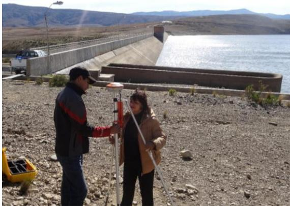
Fig. 4: Equipo utilizado para la conformación de la red geodésica.
