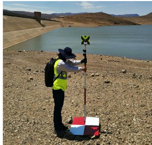
Fig. 9: Definición de puntos de control previo al vuelo.
