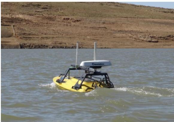
Fig. 5: Equipo utilizado para el levantamiento batimétrico.
