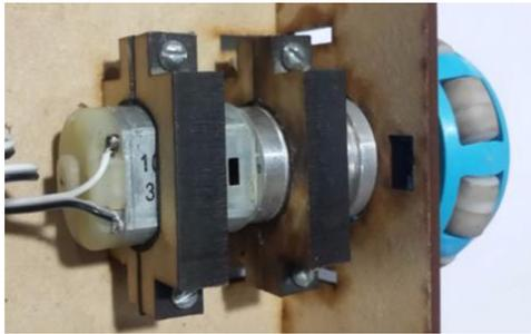
**Fig. 12:** Montaje actuador en chasis
