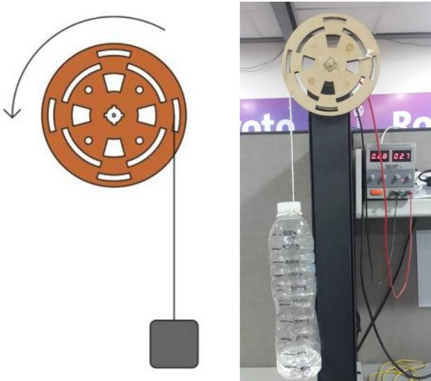
Fig. 6 Montaje para medir torque
