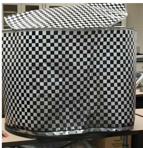
Figura 9: Tanques metálicos en escala reducida sometidos a explosión, ensayos en la Universidad de Carolina del Norte en Charlotte. (a) Tanque rígido para medición de presiones; (b) Tanque metálico de pared delgada para visualización de modos de pandeo. Fotografías de L. A. Godoy, gentileza de D. Weggel.
