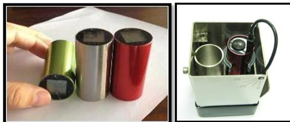
Fig. 2. Sensores electroquímicos de medición de contaminantes gaseosos Cairpol® y cabezal de protección con batería.
