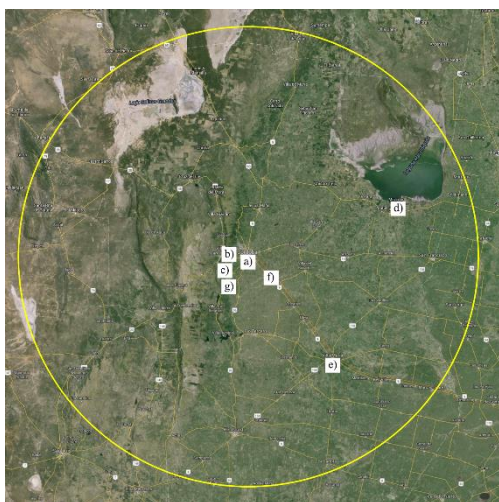
Fig. 12: Red asociada con el RMA1. a) Sitio del RMA1 en la Universidad Nacional de Córdoba (Córdoba), b) AWS-1 en Falda del Cañete, c) AWS-2 en Observatorio Astronómico de Bosque Alegre, d) AWS-3 en Miramar City e) AWS-4 en el Aeropuerto de Villa María, f) AWS-5 en la ciudad de Pilar y g) estación en Anizacate (red del INA CIRSA). La línea circular amarilla encierra el área de cobertura del RMA1 en modo intensidad (rango de 240 km).
