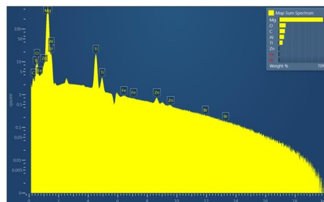
Fig. 13: Espectro de masa de la superficie de la muestra MMC10%ti.
