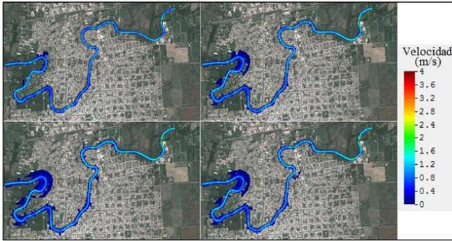
**Fig. 6.** Esquema de áreas coloreadas de la velocidad media en el plano en el río Ctalamochita en su paso por la ciudad de Bell Ville. Izquierda Superior:  $Q = 196 \text{ m}^3/\text{seg}$ , Derecha Superior:  $Q = 225 \text{ m}^3/\text{seg}$ , Izquierda Inferior:  $Q = 254 \text{ m}^3/\text{seg}$  y Derecha Inferior:  $Q = 233 \text{ m}^3/\text{seg}$ .
