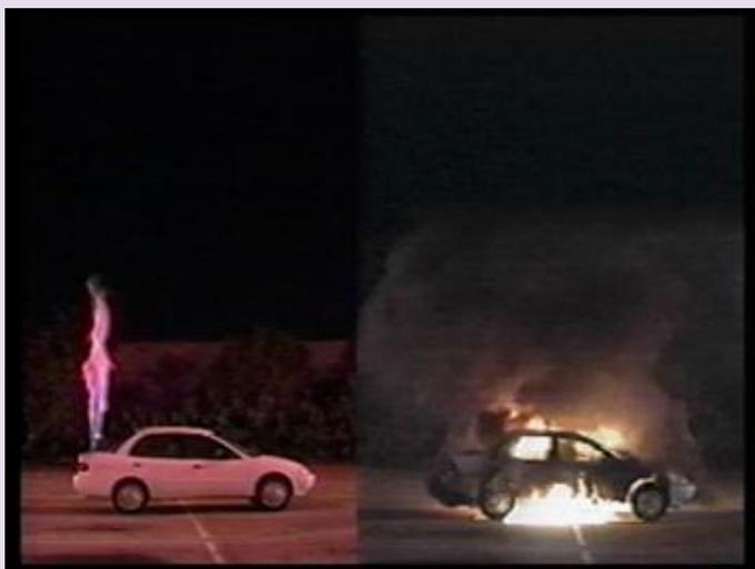
*Experimento realizado por el Dr. Swain. A la izquierda vemos un auto con un tanque de hidrógeno y a la derecha un auto con un tanque de combustible líquido.*
