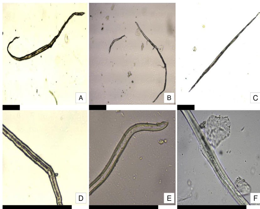
Fig. 3. Comparación entre fibras de “Papel Japón”, Broussonetia sp. y Euonymus sp. Forma. A: “Papel Japón”. B: Broussonetia sp. C: Euonymus sp. Relación pared / lumen. D: Papel Japón. E: Broussonetia sp. F: Euonymus sp. Escalas = 10 \mu m.
